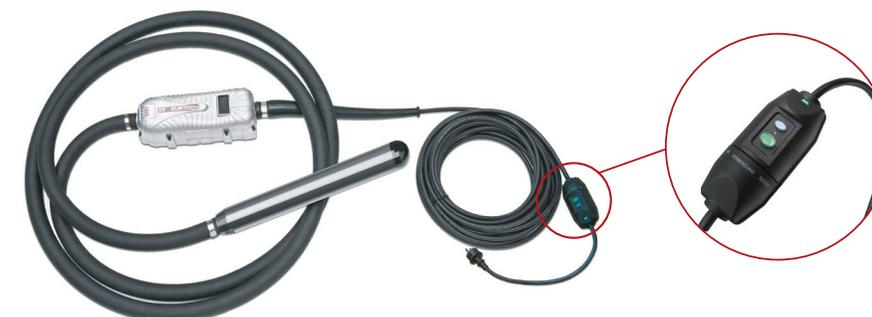
Sistema PRCD (Protective Residual Current Device) opcional, desconexión inmediata por fuga de 10mA. Para una mayor protección del usuario y del equipo cuando sea necesario.
